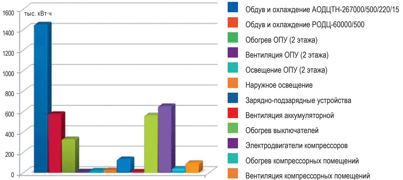
Рис. 5. Нормы расхода электроэнергии на СН ПС 500 кВ «Новокузнецкая»
