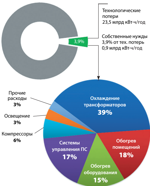
Рис. 2. Структура расхода электроэнергии на собственные нужды подстанций ПАО «ФСК ЕЭС»
