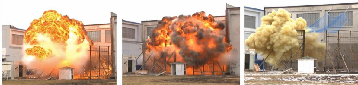
Рис. 19. Выполнение теста; ОИР с керамическим изолятором (слева), ОИР с композитным изолятором (посередине) и РИР с композитным изолятором, заполненным гелем (справа).
