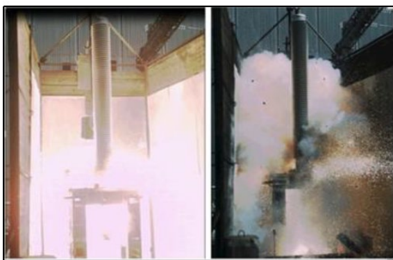
Рис. 6: Испытание на к.з. на вводе сухого типа
