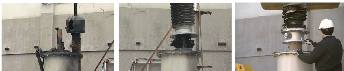
Рис. 20. Визуальный эффект на разных вводах. ОИР с керамическим изолятором (слева), ОИР с композитным изолятором (посередине) и РИР с композитным изолятором, заполненным гелем (справа).
