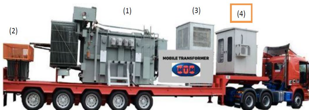
Рис. 1 Обзор мобильного силового трансформатора
