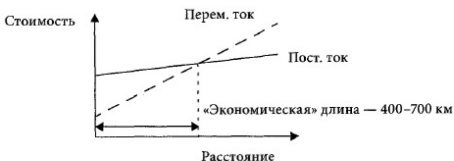
Рисунок 4 – Сравнение стоимости воздушных линий постоянного и переменного тока
